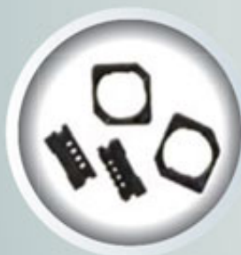
產品名稱：VCM 固定座 塑 料：LCP 尺 寸：8*8*2 (mm)
